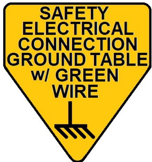
**LASER TABLES MUST BE GROUNDED TO THE WALL GREEN WIRE POINT PRIOR TO ENERGIZING LASERS AND OTHER ELECTRICAL UNITS ON TABLE**
